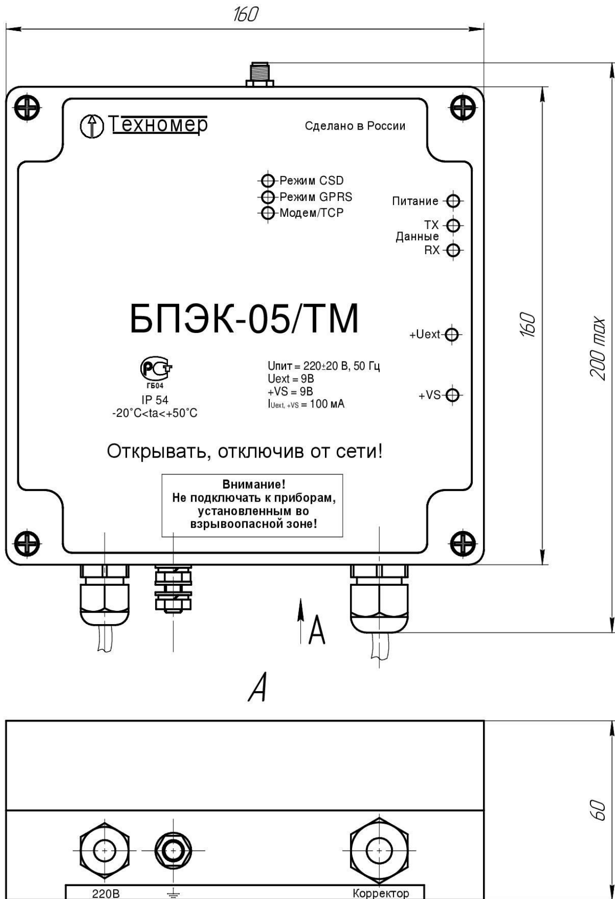
Рисунок 3. Габаритные размеры блока питания БПЭК-05/ТМ
