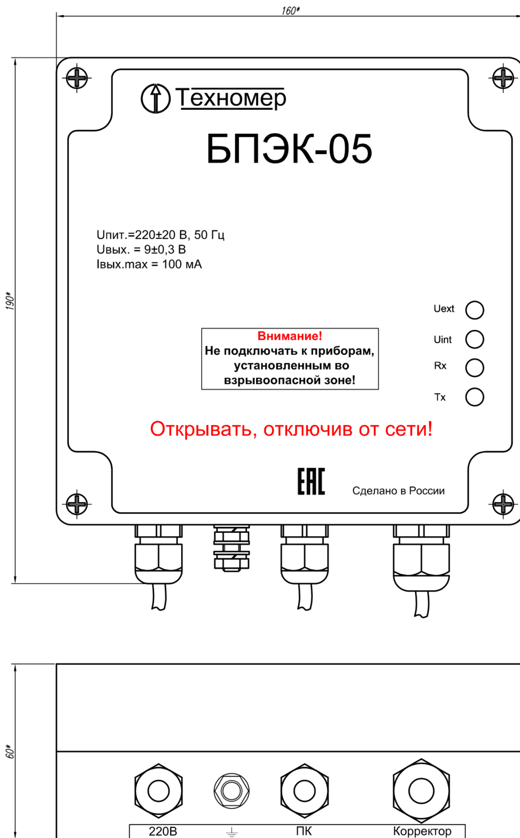
Рисунок 1. Габаритные размеры блока питания БПЭК-05
